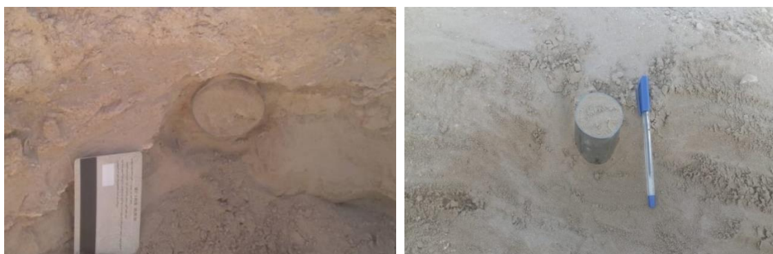
شکل ۱۳- اندازه‌گیری چگالی خشک برجای خاک با استفاده از رینگ
