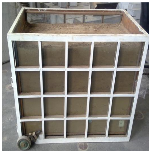
شکل ۳- مخزن ساخته شده برای نگهداری خاک
